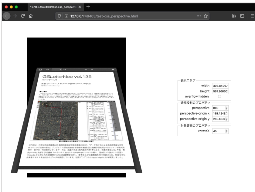
HTML の iframe で表示した Web ページを画面奥にかたむけて表示
